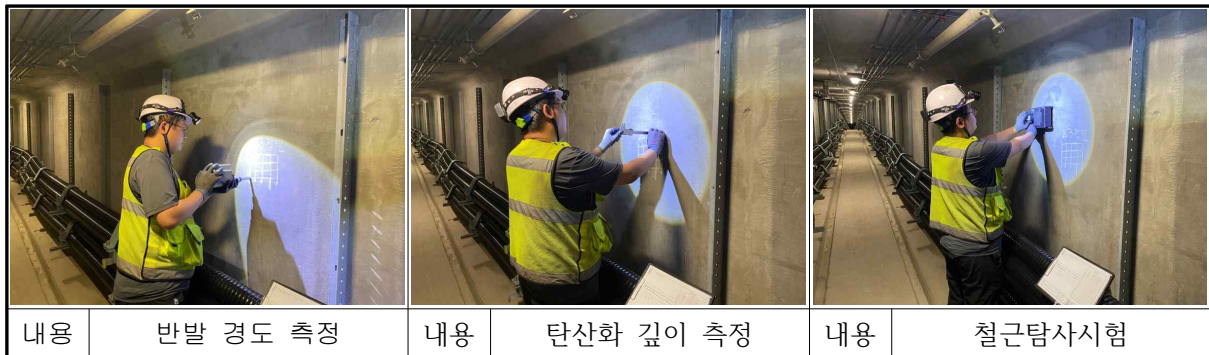
【사진 12.4】 호수인출 전력구 재료시험 전경
